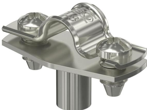
Collare distanziatore per il montaggio di tubi e cavi a parete, soffitto e pavimento. Con parte superiore autobloccante. Fissaggio sopra supporto con filettatura interna. Superfici G ed FT a partire dalla dimensione 20 dei collari adatte per montaggio con sparabulloni o sparachiodi.
