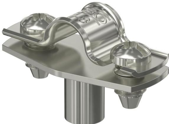
Collier d'écartement pour le montage de tubes et câbles au mur, au plafond et au sol. Avec partie supérieure autobloquante. Fixation par l'embase avec filetage intérieur. Surfaces G et FT à partir de la taille 20 des colliers convenant au montage avec cloueur ou pistolet de scellement.
