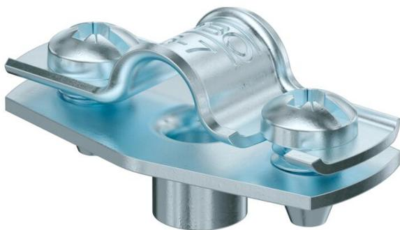
Collier d'écartement pour le montage de tubes et câbles au mur, au plafond et au sol. Avec partie supérieure autobloquante. Fixation par l'embase avec filetage intérieur.
