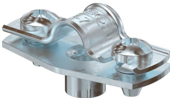
Collier d'écartement pour le montage de tubes et câbles au mur, au plafond et au sol. Avec partie supérieure autobloquante. Fixation par l'embase avec filetage intérieur. Surfaces G et FT à partir de la taille 20 des colliers convenant au montage avec cloueur ou pistolet de scellement.
