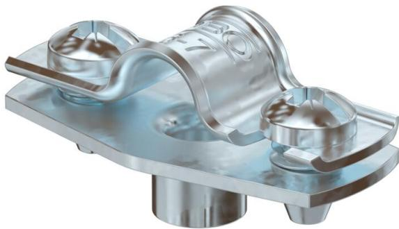
Abstandschelle zur Montage von Rohren und Kabeln an Wand, Decke und Boden. Mit selbstsicherndem Oberteil. Befestigung über Ansatz mit Innengewinde. Oberflächen G und FT ab Schellengröße 20 geeignet für Montage mit Nagelgerät oder Bolzensetzgerät.
