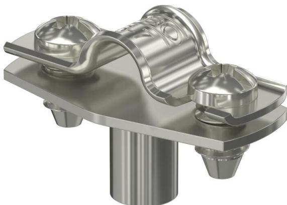
Collare distanziatore per il montaggio di tubi e cavi a parete, soffitto e pavimento. Con parte superiore autobloccante. Fissaggio sopra supporto con filettatura interna. Superficie G ed FT a partire dalla dimensione 20 dei collari adatte per montaggio con sparabulloni o sparachiodi.
