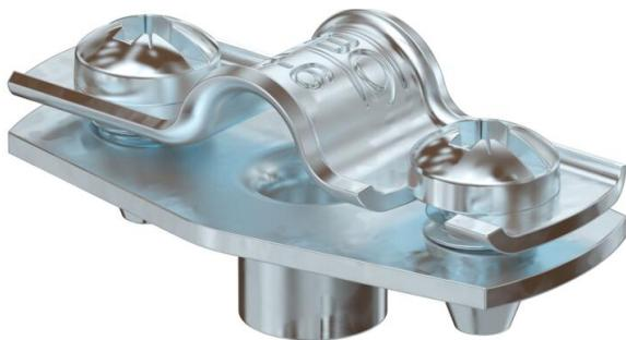
Collare di fissaggio per il montaggio di tubi e cavi a parete, soffitto e pavimento. Con elemento superiore autobloccante. Fissaggio sopra supporto con filettatura interna. Superficie G ed FT a partire dalla dimensione 20 dei collari adatte per montaggio con sparabulloni o sparachiodi.
