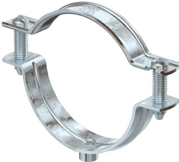
Collare di fissaggio per il montaggio di tubi e cavi a parete, soffitto e pavimento. Con elemento superiore autobloccante. Fissaggio sopra supporto con filettatura interna. Superficie G ed FT a partire dalla dimensione 20 dei collari adatte per montaggio con sparabulloni o sparachiodi.
