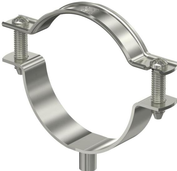
Collare distanziatore per il montaggio di tubi e cavi a parete, soffitto e pavimento. Con parte superiore autobloccante. Fissaggio sopra supporto con filettatura interna. Superficie G ed FT a partire dalla dimensione 20 dei collari adatte per montaggio con sparabulloni o sparachiodi.
