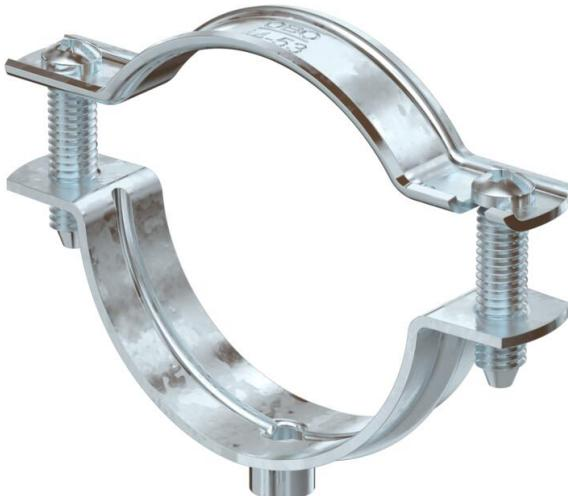
Collare di fissaggio per il montaggio di tubi e cavi a parete, soffitto e pavimento. Con elemento superiore autobloccante. Fissaggio sopra supporto con filettatura interna. Superficie G ed FT a partire dalla dimensione 20 dei collari adatte per montaggio con sparabulloni o sparachiodi.
