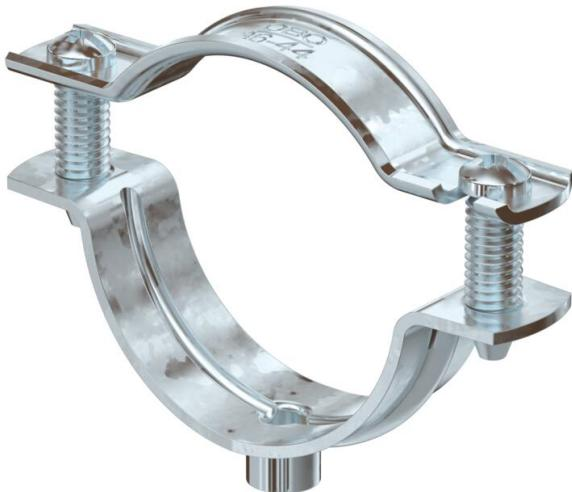
Abstandschelle zur Montage von Rohren und Kabeln an Wand, Decke und Boden. Mit selbstsicherndem Oberteil. Befestigung über Ansatz mit Innengewinde. Oberflächen G und FT ab Schellengröße 20 geeignet für Montage mit Nagelgerät oder Bolzensetzgerät.
