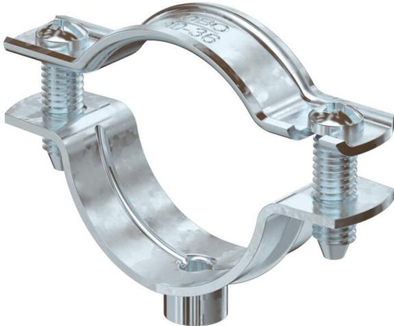
Collare di fissaggio per il montaggio di tubi e cavi a parete, soffitto e pavimento. Con elemento superiore autobloccante. Fissaggio sopra supporto con filettatura interna. Superficie G ed FT a partire dalla dimensione 20 dei collari adatte per montaggio con sparabulloni o sparachiodi.
