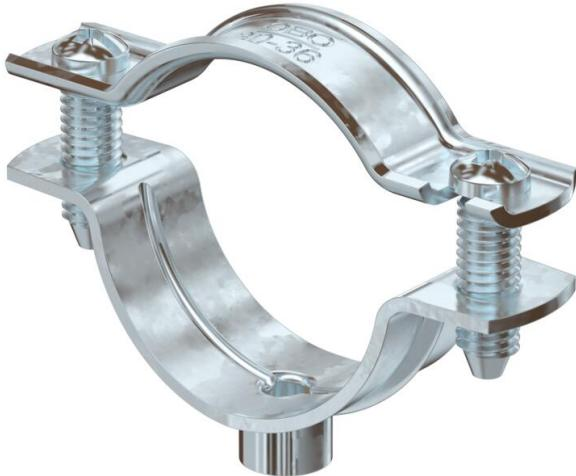
Abstandschelle zur Montage von Rohren und Kabeln an Wand, Decke und Boden. Mit selbstsicherndem Oberteil. Befestigung über Ansatz mit Innengewinde. Oberflächen G und FT ab Schellengröße 20 geeignet für Montage mit Nagelgerät oder Bolzensetzgerät.
