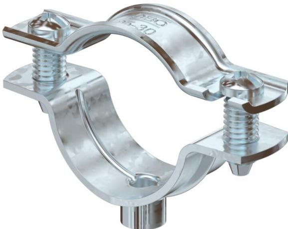
Collare di fissaggio per il montaggio di tubi e cavi a parete, soffitto e pavimento. Con elemento superiore autobloccante. Fissaggio sopra supporto con filettatura interna. Superficie G ed FT a partire dalla dimensione 20 dei collari adatte per montaggio con sparabulloni o sparachiodi.
