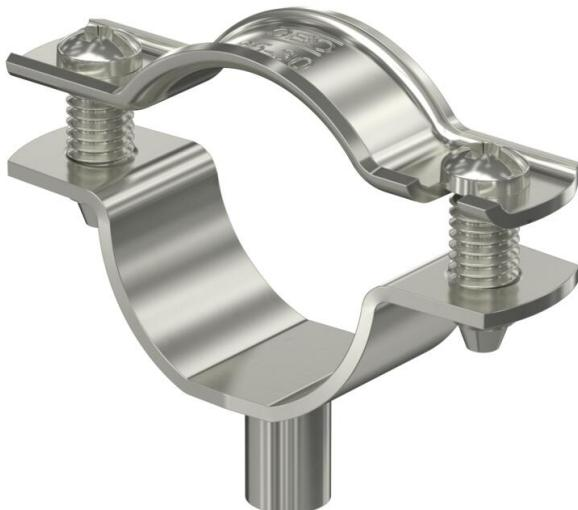
Abstandschelle zur Montage von Rohren und Kabeln an Wand, Decke und Boden. Mit selbstsicherndem Oberteil. Befestigung über Ansatz mit Innengewinde. Zugelassen für den Funktionserhalt nach DIN 4102 Teil 12, Funktionserhaltklassen E 30 bis E 90.
