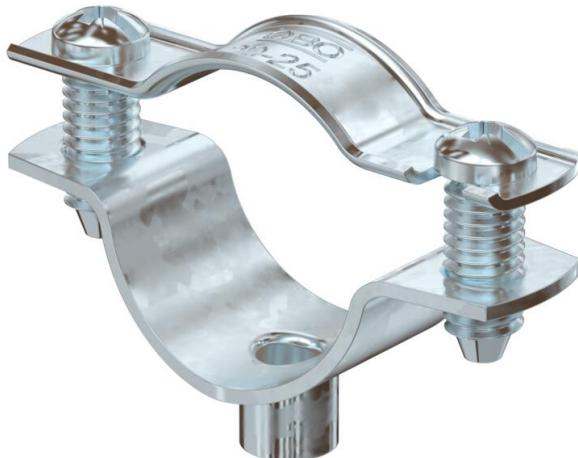
Abstandschelle zur Montage von Rohren und Kabeln an Wand, Decke und Boden. Mit selbstsicherndem Oberteil. Befestigung über Ansatz mit Innengewinde. Oberflächen G und FT ab Schellengröße 20 geeignet für Montage mit Nagelgerät oder Bolzensetzgerät.
