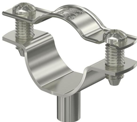
Collare distanziatore per il montaggio di tubi e cavi a parete, soffitto e pavimento. Con parte superiore autobloccante. Fissaggio sopra supporto con filettatura interna. Superfici G ed FT a partire dalla dimensione 20 dei collari adatte per montaggio con sparabulloni o sparachiodi.
