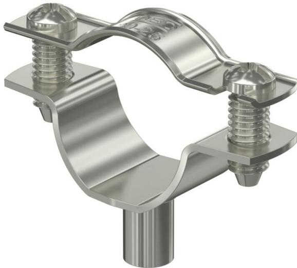
Abstandschelle zur Montage von Rohren und Kabeln an Wand, Decke und Boden. Mit selbstsicherndem Oberteil. Befestigung über Ansatz mit Innengewinde. Zugelassen für den Funktionserhalt nach DIN 4102 Teil 12, Funktionserhaltklassen E 30 bis E 90.
