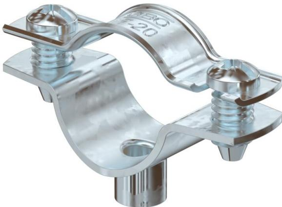
Collare di fissaggio per il montaggio di tubi e cavi a parete, soffitto e pavimento. Con elemento superiore autobloccante. Fissaggio sopra supporto con filettatura interna. Superficie G ed FT a partire dalla dimensione 20 dei collari adatte per montaggio con sparabulloni o sparachiodi.
