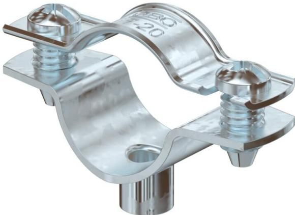
Abstandschelle zur Montage von Rohren und Kabeln an Wand, Decke und Boden. Mit selbstsicherndem Oberteil. Befestigung über Ansatz mit Innengewinde. Oberflächen G und FT ab Schellengröße 20 geeignet für Montage mit Nagelgerät oder Bolzensetzgerät.
