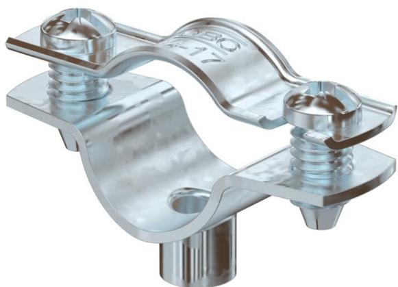
Abstandschele zur Montage von Röhren und Kabeln an Wand, Decke und Boden. Mit selbstsicherndem Oberteil. Befestigung über Ansatz mit Innengewinde. Oberflächen G und FT ab Schellengröße 20 geeignet für Montage mit Nagelgerät oder Bolzensetzgerät. Zugelassen für den Funktionserhalt nach DIN 4102 Teil 12, Funktionserhaltklassen E 30 bis E 90.
