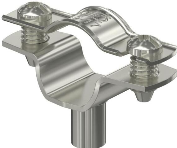
Collare distanziatore per il montaggio di tubi e cavi a parete, soffitto e pavimento. Con parte superiore autobloccante. Fissaggio sopra supporto con filettatura interna. Superficie G ed FT a partire dalla dimensione 20 dei collari adatte per montaggio con sparabulloni o sparachiodi.
