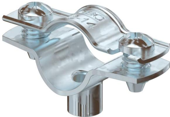
Collier d'écartement pour le montage de tubes et câbles au mur, au plafond et au sol. Avec partie supérieure autobloquante. Fixation par l'embase avec filetage intérieur. Surfaces G et FT à partir de la taille 20 des colliers convenant au montage avec cloueur ou pistolet de scellement.
