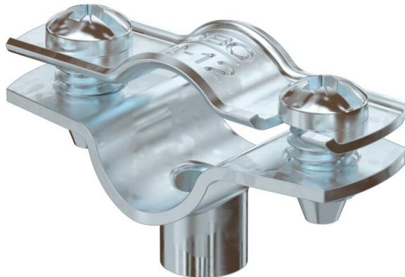
Abstandschelle zur Montage von Rohren und Kabeln an Wand, Decke und Boden. Mit selbstsicherndem Oberteil. Befestigung über Ansatz mit Innengewinde. Oberflächen G und FT ab Schellengröße 20 geeignet für Montage mit Nagelgerät oder Bolzensetzgerät.
