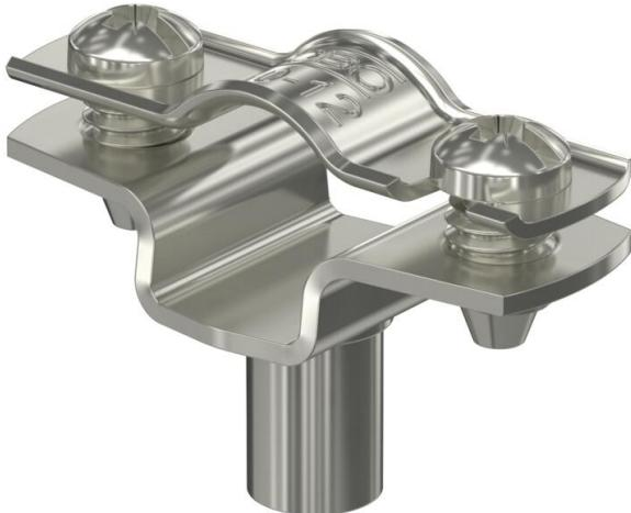
Collare distanziatore per il montaggio di tubi e cavi a parete, soffitto e pavimento. Con parte superiore autobloccante. Fissaggio sopra supporto con filettatura interna. Superfici G ed FT a partire dalla dimensione 20 dei collari adatte per montaggio con sparabulloni o sparachiodi.
