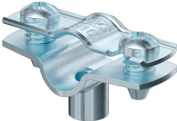
Collare di fissaggio per il montaggio di tubi e cavi a parete, soffitto e pavimento. Con elemento superiore autobloccante. Fissaggio sopra supporto con filettatura interna.
