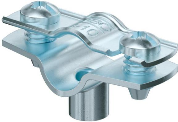
Abstandschelle zur Montage von Rohren und Kabeln an Wand, Decke und Boden. Mit selbstsicherndem Oberteil. Befestigung über Ansatz mit Innengewinde. Zugelassen für den Funktionserhalt nach DIN 4102 Teil 12, Funktionserhaltklassen E 30 bis E 90.
