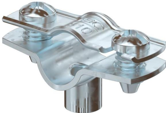
Collier d'écartement pour le montage de tubes et câbles au mur, au plafond et au sol. Avec partie supérieure autobloquante. Fixation par l'embase avec filetage intérieur. Surfaces G et FT à partir de la taille 20 des colliers convenant au montage avec cloueur ou pistolet de scellement.
