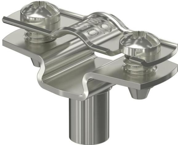
Abstandschelle zur Montage von Rohren und Kabeln an Wand, Decke und Boden. Mit selbstsicherndem Oberteil. Befestigung über Ansatz mit Innengewinde. Zugelassen für den Funktionserhalt nach DIN 4102 Teil 12, Funktionserhaltklassen E 30 bis E 90.
