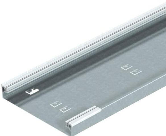
Parte inferiore canale di installazione a pavimento, a 1 via, per coperchio cieco/di montaggio con inclinazione su un lato, con profili laterali applicabili in alluminio per la posa e il fissaggio dei coperchi del canale, sottovasca con linguette di fissaggio per max. 2 separatori applicabili e a contatto fra loro e calibrazione per messa a terra. Altezza del canale adatta all'installazione di Telitank o al montaggio di moduli apparecchi di dimensioni nominali 4, 6, 9.
