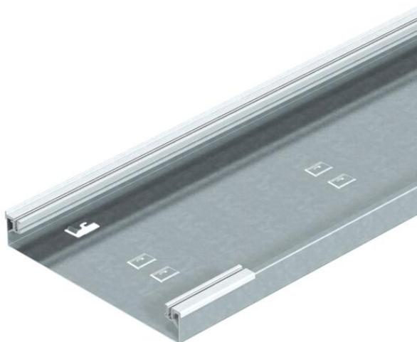
Partie inférieure de canal de sol apparent, à 1 compartiment pour couvercle plein/d'inspection, chanfreinée d'un seul côté, avec profilés latéraux en aluminium emboîtables pour accrochage et fixation des couvercles, plaque de sol avec pattes de fixation pour 2 séparateurs max. emboîtables par enclenchement automatique et empreinte pour équerre de raccordement à la terre. Hauteur de conduit adaptée au montage en saillie de Telitank ou pour le montage de boîtier de sol de taille nominale 4, 6, 9.
