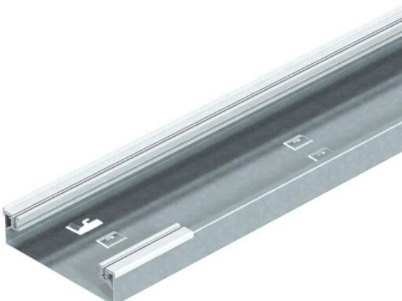
Aufflur-Installationskanal-Unterteil, 1-zügig, für Blind-/Montagedeckel mit einseitiger Abschrägung, mit aufsteckbaren Aluminium-Seitenprofilen zum Auflagern und Befestigen der Kanaldeckel, Bodenwanne mit Haltelaschen für max. 2 einsteckbare, selbstkontakterende Trennsteg und Prägung für Schutzleiteranschlusswinkel. Kanalhöhe geeignet zum Aufbau von Telitanks.
