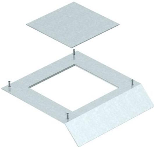
Couvercle pour socle de conduit AIK/U pour le montage d'un boîtier de sol de taille nominale 9 ; ouverture de montage fermée par un obturateur en alu de 2 mm. Le couvercle du conduit est fermement vissé sur les profilés latéraux Al du socle du conduit. Le chanfrein du couvercle dépasse le socle du conduit selon un angle de 45°.
