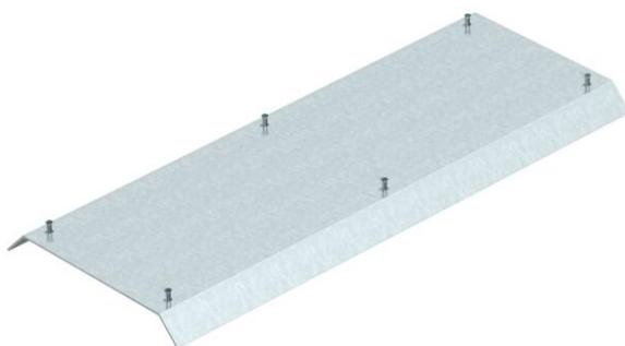
Aufflur-Blinddeckel zum Abdecken des Aufflur-Abzweigkanals AIK/A, passend zu den Kanalunterteilen AIK/U. Der Kanaldeckel wird in den Al-Seitenprofilen des Kanalunterteils festgeschraubt. Die Deckelschräge überragt das Kanalunterteil im 45°-Winkel.
