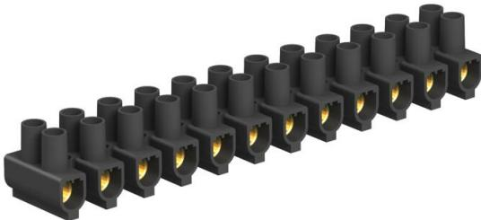
Geprüft nach EN 60998. Klemmen Messing, Schrauben Stahl, galvanisch verzinkt und transparent passiviert, 12-polige, in Einzelklemmen abtrennbare Leisten. Schrauben hochgedreht, unverlierbar. Max. zulässige Umgebungstemperatur gemäß EN 60998: -5 bis +80 °C. Nennquerschnitt 25 ÷ mm<sup>2</sup> Nennspannung 750 V Nennstrom 101 A Max. klemmbar je Seite: 25 mm<sup>2</sup> flexibel oder 16 mm<sup>2</sup> starr.
