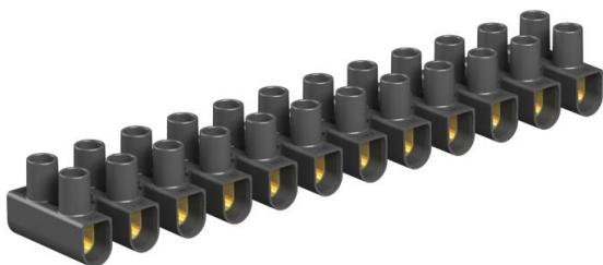
Geprüft nach EN 60998. Klemmen Stahl, Schrauben Stahl, galvanisch verzinkt, 12-polige, in Einzelklemmen abtrennbare Leisten durch "twist'n'pull". Schrauben hochgedreht, unverlierbar. Max. zulässige Umgebungstemperatur gemäß EN 60998: -5 bis +80 °C. Nennquerschnitt  $10 \text{ mm}^2$  Nennspannung 450 V Nennstrom 57 A Max. klemmbar je Seite: 10  $\text{mm}^2$  starr oder 6  $\text{mm}^2$  flexibel.
