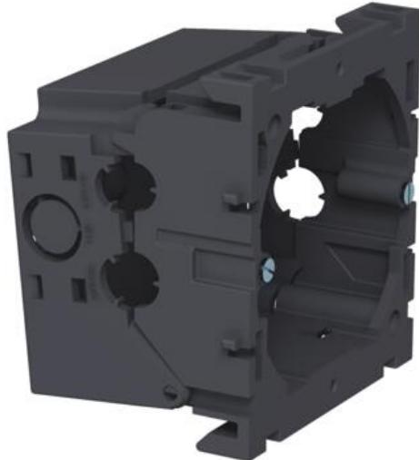
Scatola incasso apparecchi ad aggancio frontale per sistemi di interruttori con elemento inferiore ribaltabile e all'occorrenza rimovibile per rapidi collegamenti di cavi, dotata di aperture di alimentazione per cavi con diametro fino a 14 mm. Versione priva di alogenri. Guida di fissaggio orizzontale 60 mm.
