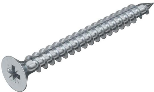
Acciaio temprato, zincato galvanicamente e rivestito con Hostaflon. Testa con fessura per cacciavite a croce (Pozidrive dim. 2 tranne Ø 6 mm Pozidrive dim. 3).
