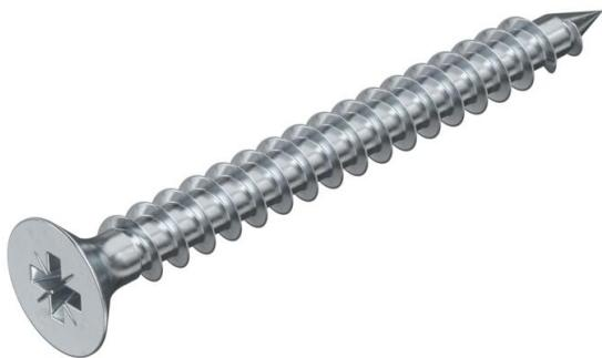
Aacier trempé et galvanisé, revêtement Hostaflon. Tête fraisée avec empreinte cruciforme (Pozidrive taille 2, sauf Ø 6 mm Pozidrive taille 3).
