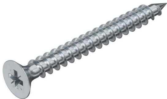
Acier trempé et galvanisé, revêtement Hostaflon. Tête fraisée avec empreinte cruciforme (Pozidrive taille 2, sauf Ø 6 mm Pozidrive taille 3).
