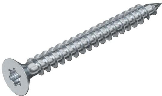
Acier trempé et galvanisé, revêtement Hostaflon. Tête fraisée avec empreinte T (six pans creux), de Ø 3 mm T10, Ø 3,5 mm T15, Ø 4 et 4,5 mm T20, Ø 5 mm T25.
