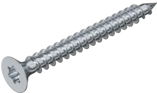
Acciaio temprato, zincato galvanicamente e rivestito con Hostaflon. Testa svasata con T-Bit (esagono interno tondo), dim. Ø 3 mm T10, Ø 3,5 mm T15, Ø 4 e 4,5 mm T20, Ø 5 mm T25.
