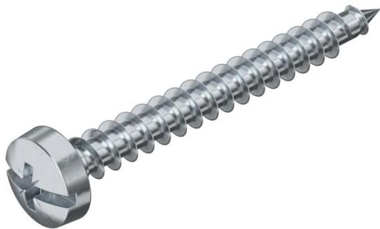
Stahl gehärtet, galvanisch verzinkt und hostafonbeschichtet. Panhead mit kombiniertem Kreuz- und Schraubendreherschlitz (Pozidrive Gr. 2 außer Ø 6 mm Pozidrive Gr. 3).
