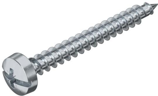
Acciaio temprato, zincato galvanicamente e rivestito con Hostaflon. Panhead con fessura per cacciavite a croce e cacciavite normale combinata (Pozidrive dim. 2 Ø esterno 6 mm Pozidrive dim. 3).
