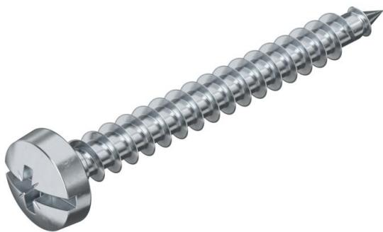
Aacier trempé, galvanisé et passivé jaune, revêtement Hostaflon. Panhead avec empreinte à tournevis plats et cruciformes (Pozidrive taille 2 sauf Ø 6 mm Pozidrive taille 3).
