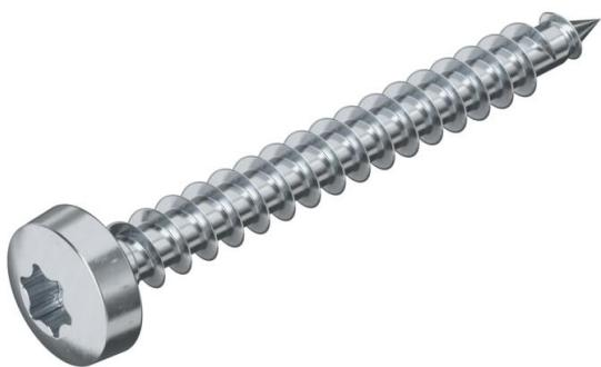
Acciaio temprato, zincato galvanicamente e rivestito con Hostaflon. Panhead con T-Bit (esagono interno tondo), dim. Ø 3 mm T10, Ø 3,5 mm T15, Ø 4 e 4,5 mm T20, Ø 5 mm T25.
