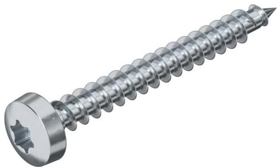
Stahl gehärtet, galvanisch verzinkt und hostaflonbeschichtet. Panhead mit T-Bit (Innensechsrund), die Gr. Ø 3 mm T10, Ø 3,5 mm T15, Ø 4 und 4,5 mm T20, Ø 5 mm T25.
