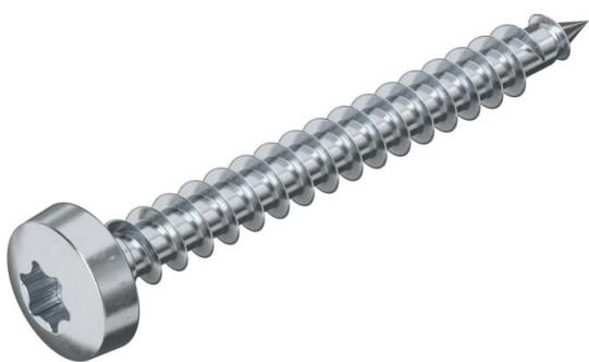
Acier trempé et galvanisé, revêtement Hostaflon. Panhead avec empreinte T (six pans creux), de Ø 3 mm T10, Ø 3,5 mm T15, Ø 4 et 4,5 mm T20, Ø 5 mm T25.
