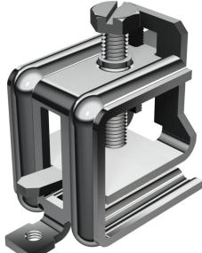
Pince de fixation à vis pour la fixation de composants sur des profilés en acier, avec alésage fileté M6 pour l'accueil de tiges filetées. Fixation à la poutre en acier ou au plat avec patin de pression et vis hexagonale M8, ouverture de clé 13 mm.
