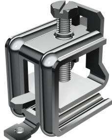
Trägerschraubklammer zur Befestigung von Bauteilen an Stahlprofilen, mit M6-Gewindebohrung zur Aufnahme von Gewindestangen. Fixierung am Stahlträger oder Flacheisen mit Druckwanne und Sechskantschraube M8, Schlüsselweite 13 mm.
